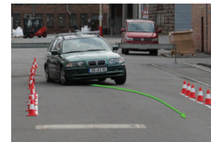
Abb. 9: Erprobung der Algorithmen zur Realisierung der autonomen Ausweichbewegung
