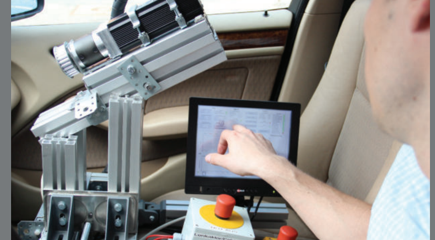
Innenansicht des Forschungsfahrzeuges mit eigens entwickelter Lenkaktorik
